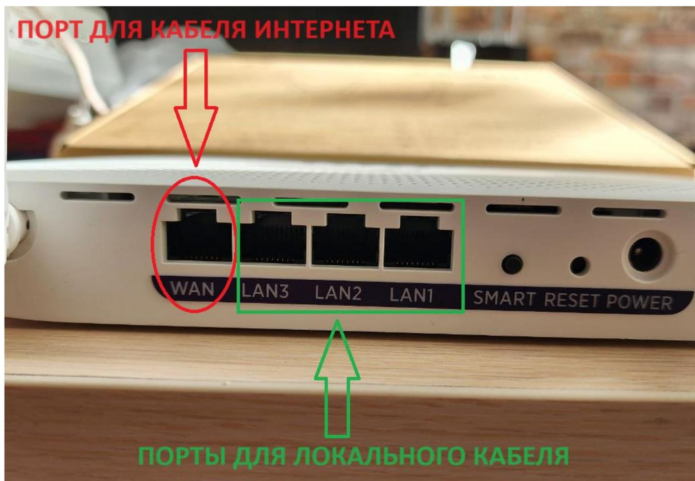
Далее настроить роутер можно двумя способами, подключившись к нему с любого устройства по WIFI или подключив его локальным кабелем, идущим в комплекте к роутеру.
